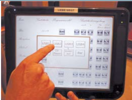
Lautstärke und Eingangsquellen können ganz einfach zentral per WLAN-Touch Screen (oben) oder vor Ort (rechts) geregelt werden
