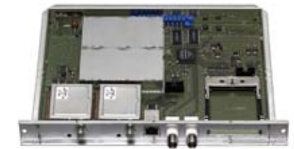
Die Kassette HDTV 1000 ASI LAN mit CI-Slot setzt zwei digitale HDTV-Sat-Signale in HDTV-Kabel-Signale um
