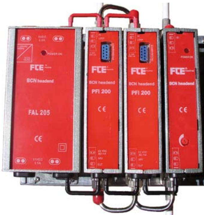
Ideal für die Umsetzung digitaler Transponder: die Einkabel-Lösung PFI 200 aus der Fte-Range
